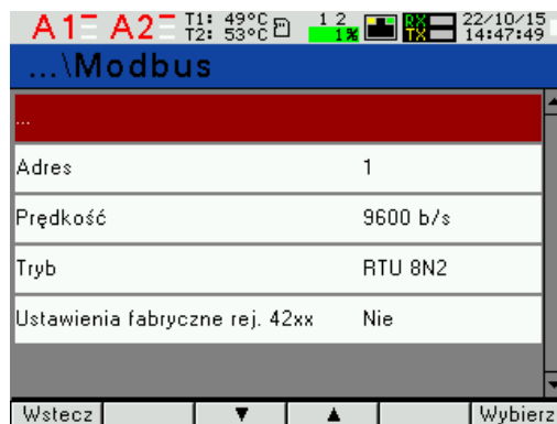
Rys.23. Ekran trybu Modbus
