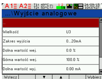
Rys.18. Ekran trybu Wyjście analogowe
